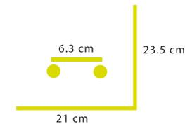
3. Con la ayuda de un taladro y con broca adecuada para el tipo de superficie, realice perforaciones de 30 mm en los puntos dibujados.
